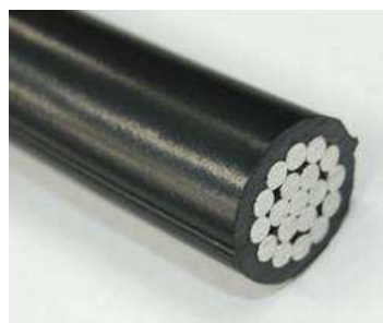
図2 リサイクルポリエチレンを用いて製造したOC電線の外観
